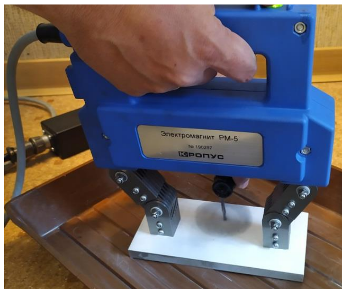
Рис. 1. Схема намагничивания контрольного образца МО-1
