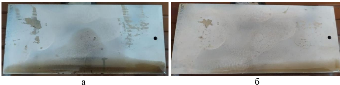
Рис. 3. Индикаторный рисунок дефектов, образованный магнитной суспензией: a – \gamma\text{-Fe}_2\text{O}_3 ; б – \text{Fe}_3\text{O}_4
